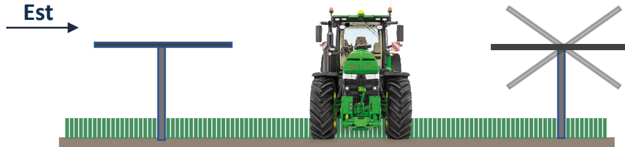
Structure avec tracker : système suivant la course du soleil
